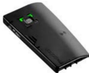
La In&box est un dispositif électronique placé dans la coque. Il est fourni avec un câble USB et son propre manuel d'utilisation. Chaque In&box possède un identifiant unique lié à un compte utilisateur. Avant d'utiliser votre In&box, veuillez lire attentivement les instructions détaillées dans le manuel d'utilisation spécifique à In&motion dédié à l'utilisation de la In&box.
