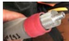
Überprüfen Sie, ob die Dichtung richtig positioniert und nicht beschädigt ist.
