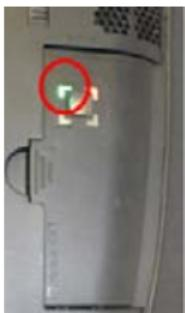
Kontrollera att tryckpumpen är ny och korrekt ansluten genom att aktivera In&box och placera den i dess hölje. LED-lampan på tryckpumpen ska nu lysa grön.
