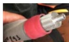
Controleer of de afdichting correct is geplaatst en niet beschadigd is.
