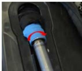
Schroef het nieuwe opblaassysteem met de hand vast.
