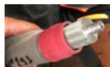
Vérifier que le joint est correctement positionné et qu'il n'est pas endommagé.
