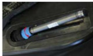
**Avvertenza!** Per evitare il danneggiamento, non forzare il connettore e non tirare il cavo per rimuovere il gonfiatore.
