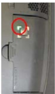
Pour vérifier que le gonfleur est neuf et correctement connecté, prendre la In&box, la mettre en place et l'insérer dans son boîtier. La LED du gonfleur doit passer au vert.
