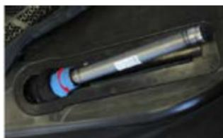
**¡Advertencia!** Para evitar dañarlo, no fuerce el conector ni tire del cable para extraer el inflador.
